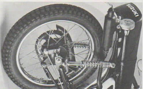
Gleich von Haus aus wird das Modell 79 mit einem 2,75 x 17 Gelände-Hinderradreifen ausgerüstet. Die Telegabel und die Federbeine sind ölgedämpft. Aber bei aller Geländetauglichkeit – mit diesem Mottick kann man auch ebensogut zu zweit in der Stadt unterwegs sein.
